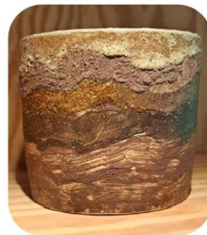
Na steengoed stook op 1240°C
